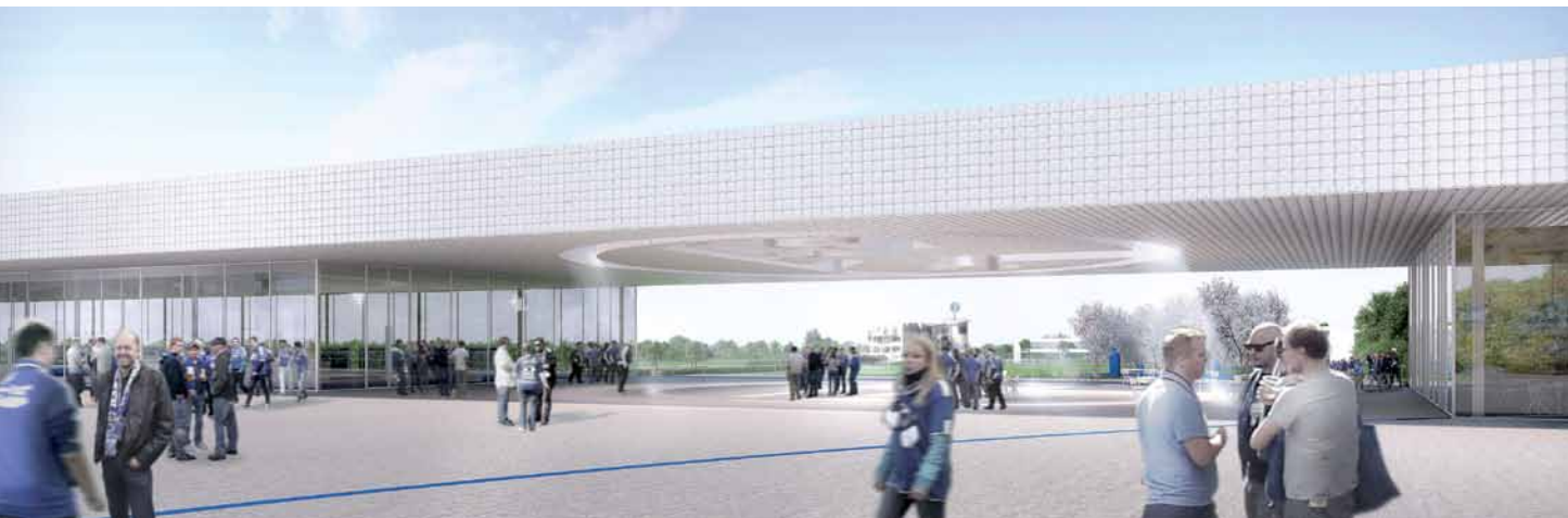
Der Entwurf sieht ein 150 Meter langes Dach mit weiß emaillierten Metallschindeln vor. Das Vereinswappen soll als Hohlkörper aus Stahlblech mit eingeschweißten Stegen in das Dachtragwerk eingehängt werden.
